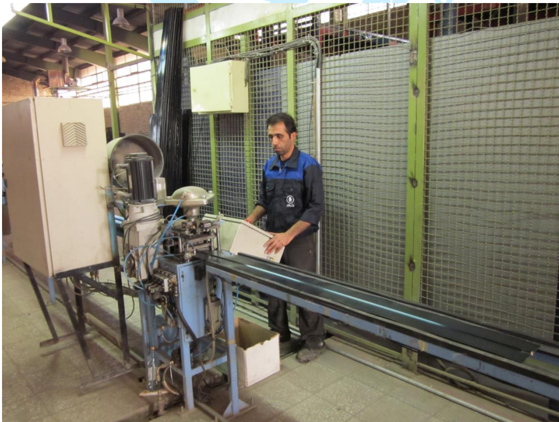
شکل ۴- خط تولید صفحه جاذب فراسا بعد از پوشش دهی - عملیات اتصال لوله مسی
