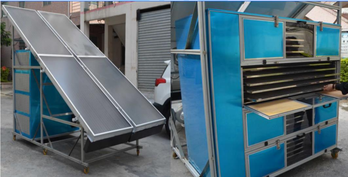
شکل ۱۹- خشک کن خورشیدی هوای گرم -خانگی با ظرفیت ۱۸۰ کیلوگرم میوه تر و قابلیت جابجایی
