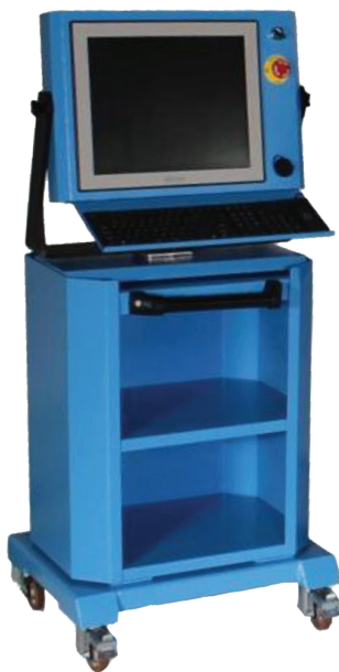
پانل کنترل پیاده‌سازی شده بر اساس HMI
